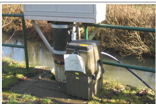
Bild 5: Messeinrichtung zur Erfassung von Pflanzenschutzmitteln in Oberflächengewässern
