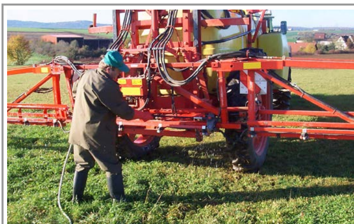
Bild 4: Sachgerechte Reinigung der Feldspritze
