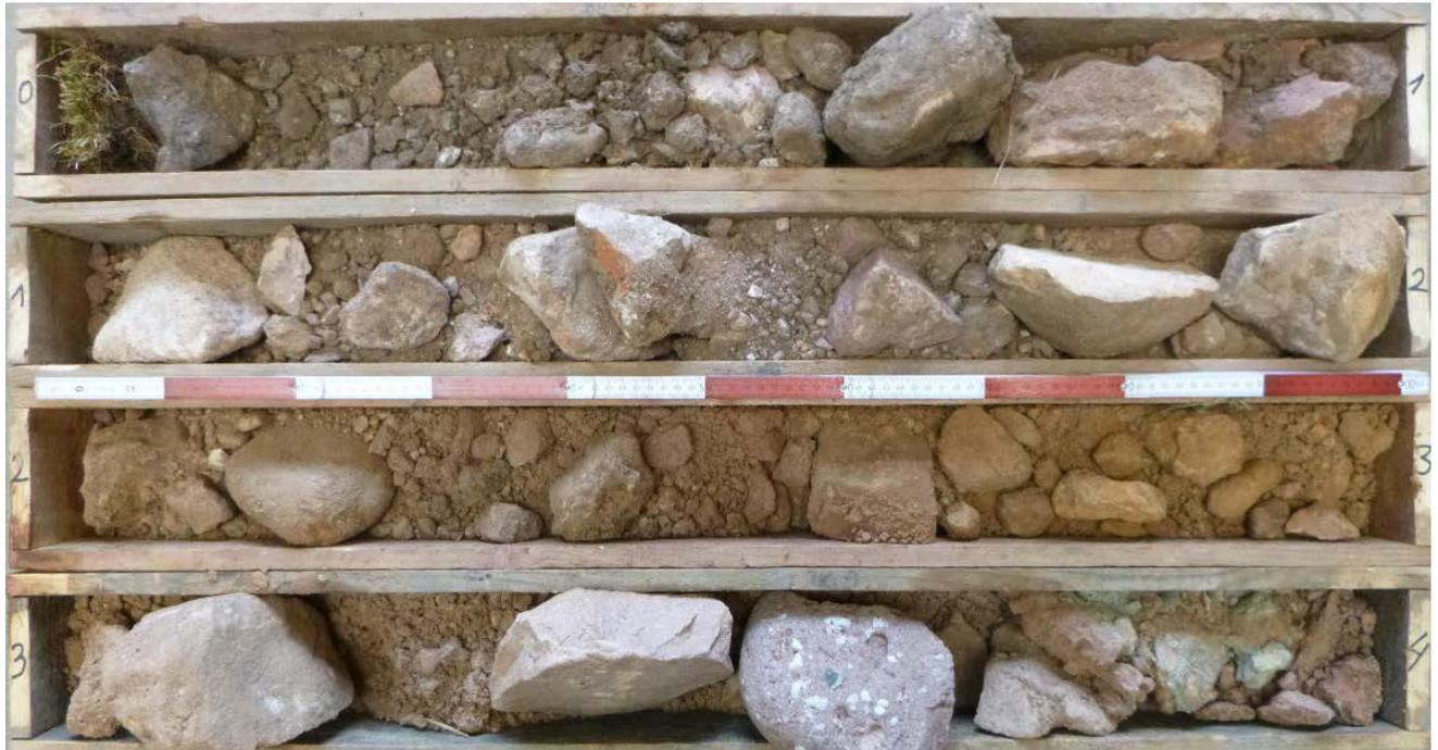
**Abbildung 5.1:** Bohrkern der Bohrung KB 1 vom Tiefenbereich 1,00 m bis 4,00 m u.GOK. Beachte: den Übergang von kantigen Gesteinsbruchstücken in der grauen Auffüllung (Schicht 2, Tiefenbereich 0,10 m – 1,80 m u.GOK) zu kantengerundeten Bruchstücken in den rötlich bis ockerfarbenen Verschwemmungssedimenten (Schicht 3, Tiefenbereich 1,80 m bis 3,80 m u.GOK).
