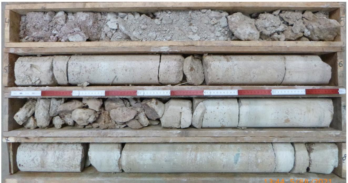
**Abbildung 5.2:** Bohrkern der Bohrung KB 2 vom Tiefenbereich 4,00 m bis 8,00 m u.GOK. Beachte: die angetroffenen Verwitterungsstufen des Tigerstandsteins (a) w 4 – w 5 (Schicht 4a, Tiefenbereich 4,00 m bis 5,00 m u.GOK), (b) w 3 (Schicht 4a, Tiefenbereich 6,00 m bis 6,60 m u.GOK und (c) w 2 (Schicht 4b, Tiefenbereich 5,00 m bis 6,00 m u.GOK und 6,60 m bis 8,00 m u.GOK).
